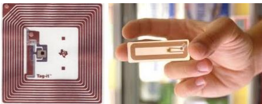
شکل شماره 2: نمونه‌هایی از برچسب شناسایی مبتنی بر امواج رادیویی
